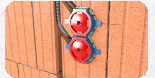
8. Den nach außen gewölbten Putzdeckel zum Schutz der Schraubdomen, des Doseninneren und zur Reduktion des Putzauftrages auf die Öffnung der Dose aufsetzen.
