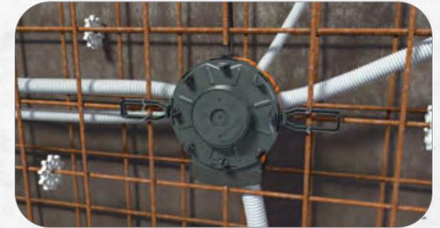
2. Membrane mit einem Cuttermesser öffnen. Werkzeuglose Kombieführung von Kabeln und (starr)en Röhren von M9 – M40. Die Membrantechnik gewährt eine absolut betondichte Einführung.
