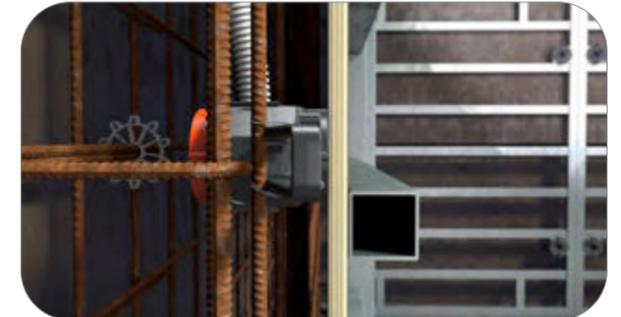
Für unterschiedliche Betondeckungen kann die Betondose um 180 Grad gedreht werden. Flügel mit Draht an der Stahlarmierung befestigen. Flexible Flügel passen sich der jeweiligen Betondeckung an.
