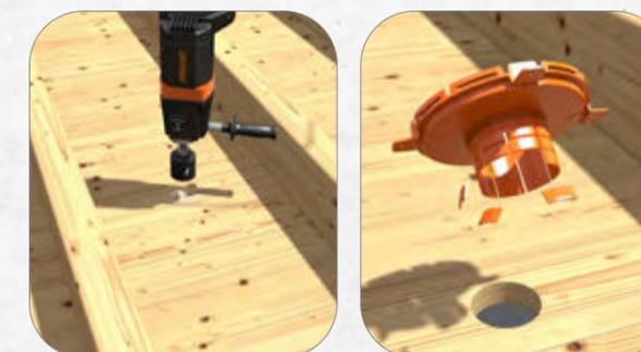
1. 74 mm Bohrung in die Sichtschalung einbringen. Dazu eignet sich eine handelsübliche Lochsäge. Bei Bedarf die Installationssegmente abtrennen, um die Einbautiefe der Deckenstärke anzupassen. Uni-Flexx anschließend ins Bohrloch stecken.
