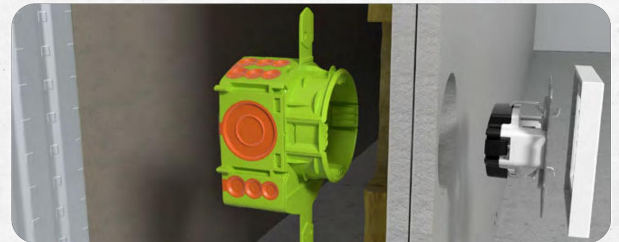
Die UniQ Hohlwand Geräte-V-Dose wird von hinten durch die Bohrung gesetzt. Die Wand ist daher noch offen und Leitungen sowie Rohre können bequem eingeführt werden.
