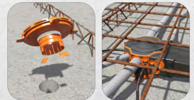
**Uni-Flexx** in das Bohrloch stecken und mit Schlagdübeln auf der Decke befestigen. Einbaugehäuse XL 150 aufsetzen. Trafotunnel kann optional angebracht werden.
