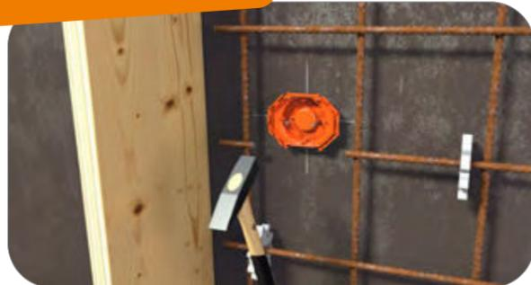
Positionsgenau ausrichten durch integrierte Markierungen am Deckel. Integrierte Nagelfixierung im Deckel ermöglicht eine einfache Montage. Stabiles Aneinanderreihen weiterer Deckel im Kombinationsabstand von 71 mm möglich.
