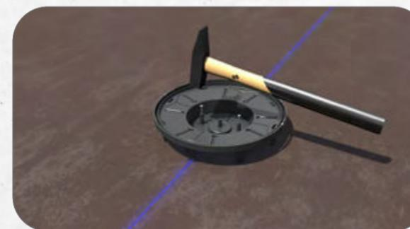
1. Einbaugehäuse mithilfe der integrierten Markierung am Frontteil positionsgenau auf der Schalung ausrichten. Einfache und schnelle Montage durch die integrierte Nagelfixierung. Wurde die Armierung bereits eingebracht, hilft der Primo Nagler für eine einfache und verletzungsfreie Befestigung.
