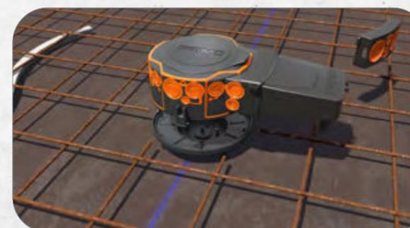
3. Einbaugehäuse auf Frontteil aufsetzen. Der optionale zusätzliche Universal-Trafotunnel bietet hohe Flexibilität bei der Installation. Anschließend ist das Einbaugehäuse weiterhin um 360 Grad ausrichtbar. Stützen unterhalb des Universal-Trafotunnels sorgen dafür, dass keine weitere Armierung ausgeschnitten werden muss.
