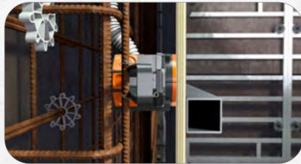
2. Flexible Flügel passen sich der jeweiligen Betondeckung an. Betondeckungen zwischen 20–40 mm oder 40–60 mm möglich. Nach dem Stellen der Gegenschalung kann betoniert werden.
