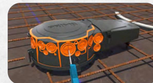
4. Membran mit Cuttermesser öffnen. Kabel und (starre) Rohre wie gewünscht ohne zusätzliches Werkzeug einführen. Das System bleibt dank der Membrantechnik absolut betondicht. Die Kombieinführungen bieten Platz für Kabel und Rohre der Größen M9 bis M40.
