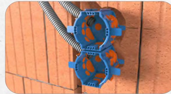
7. Die Membranrastzähne fixieren die Dose schon vor dem Einschäumen fest im Loch. So können Thermodosen auch bereits verrohrt montiert und dann erst eingeschäumt werden.
