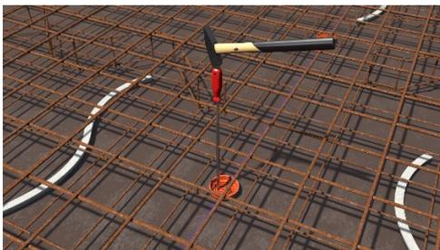
Wurde die zweite Bewehrung bereits angebracht, kann das Frontteil mit dem Primo Nagler positioniert und aufgenagelt werden.
