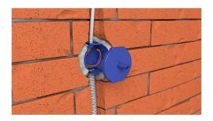
Bohrloch für Dosenunterteil fräsen. Dosenunterteil bündig setzen, Leitungen und Rohre einführen. Bohrdeckel (P003) auf das Dosenunterteil aufstecken.
