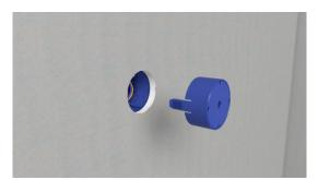
Mit Dosenfräser Loch ausfräsen und Bohrdeckel entfernen. Dosenoberteil putzbündig einrasten.
