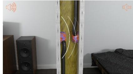
Für Schallschutzwände (100 mm Wandstärke) bis 58 dB, auch bei gegenüberliegendem Einbau der Dosen.
